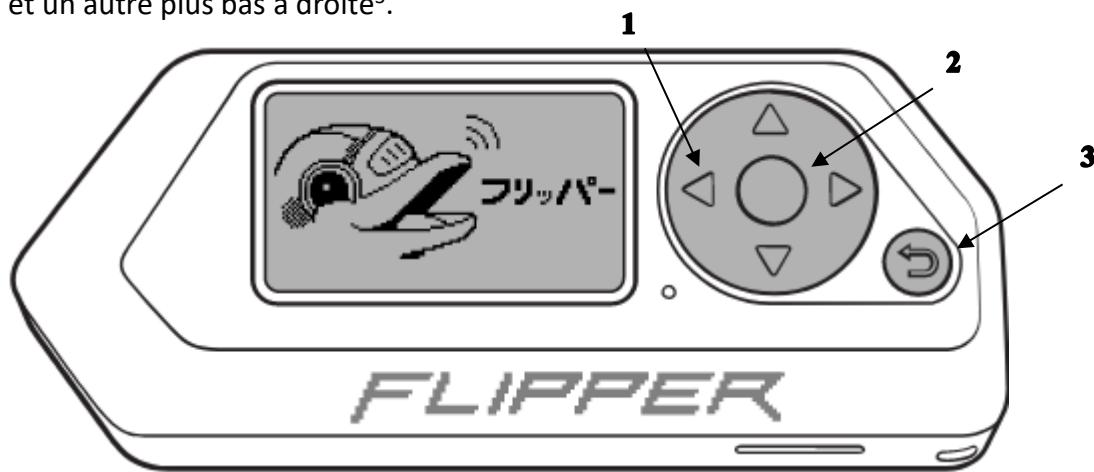
Vous pouvez l'**allumer** avec le bouton en bas à droite<sup>3</sup> et le **redémarrer** avec la flèche directionnel gauche<sup>1</sup> et le bouton en bas à droite<sup>3</sup>.
